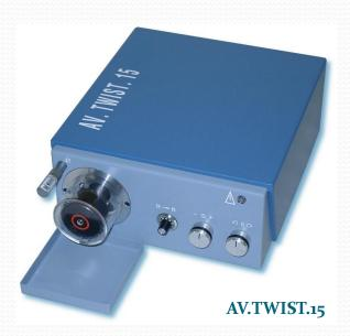
La **AV.TWIST.15** è un' unità per spelare e attorcigliare, ideale per processare cavi unipolari con sezione di ca. 0,03 mm² - 4 mm² e con diametro esterno di 4,5 mm (a seconda delle caratteristiche dell'isolante).
